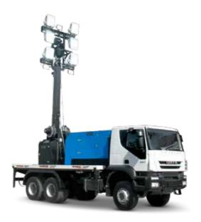
20-m-Lichtmast mit 100-kVA-Generator auf Iveco Maxi Truck
