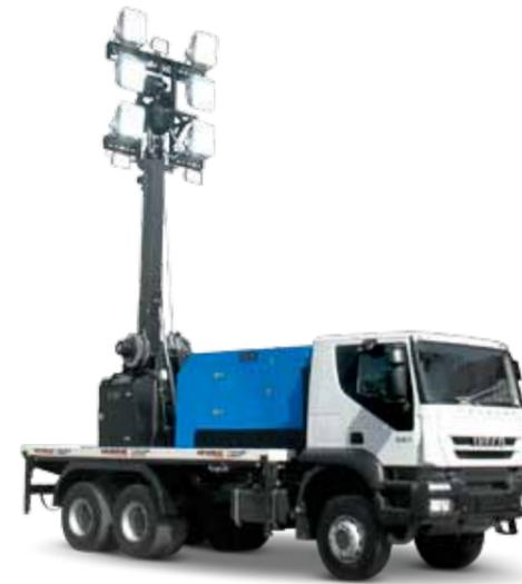
20-m-Lichtmast mit 100-kVA-Generator auf Iveco Maxi Truck
