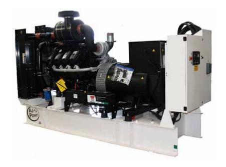
Leistungsangaben basierend auf: 3-phasig, 400/230 V, 50 HZ, cos,-phi 0,8 auch in 1-phasig und 60 HZ Modellen erhältlich
